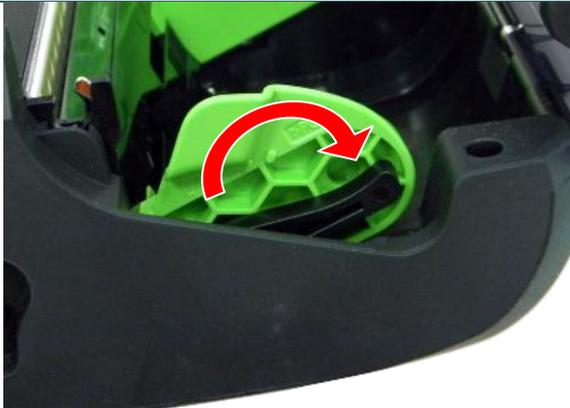
2. Empuje hacia abajo cada lado del conmutador de bloqueo de la montura de soportes para fijar dicha montura.
