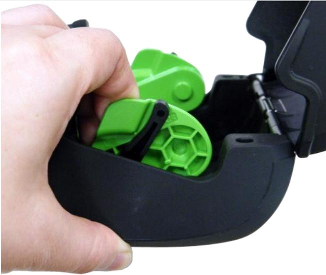
1. Abra la tapa de soportes de la impresora presionando el botón de liberación de la misma. Separe las monturas de soportes conforme al ancho del soporte.
