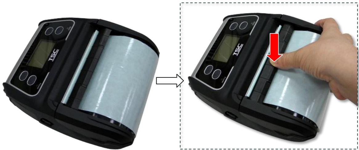
7. Presione hacia abajo el módulo de exfoliación para bloquearlo.
