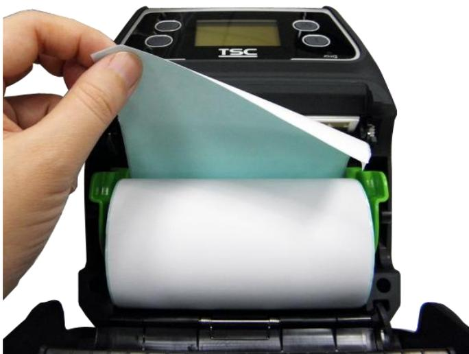
3. Coloque el rollo entre las monturas de soportes y ciérrelas en el núcleo. Coloque el papel, con el lado de impresión hacia arriba y extraiga suficiente papel sobre el cabezal de impresión.
