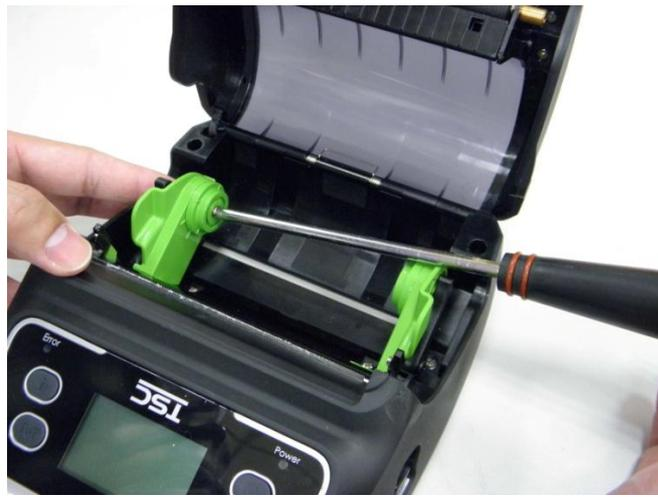
5. Apriete el tornillo en la tuerca para fijar el adaptador en la montura de soportes.
