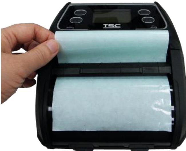
4. Inserte el revestimiento a través del módulo de exfoliación tal y como se muestra en la figura.
